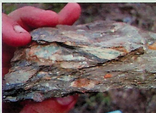
Figura 12 - Detalhe do metadiamictito ferruginoso com clastos variados (MF).
